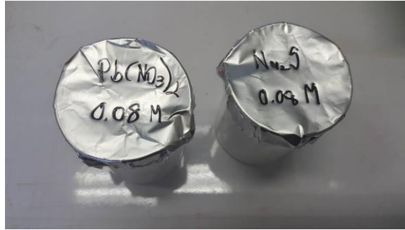
รูปที่ 3.24 ความเข้มข้น 0.08 โมลาร์ ของเลดไดไนเตรตและโซเดียมซัลไฟด์ทำละลายในเมทานอล
