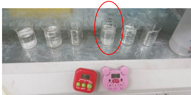
รูปที่ 3.16 จุ่มวัสดุรองรับลงในบีกเกอร์ที่ 4 โซเดียมซัลไฟด์ทำละลายในเมทานอล 0.02 โมลาร์
