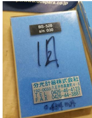
รูปที่ 3.60 เซนเซอร์วัดปริมาณแสง ใช้สำหรับวัดค่าพารามิเตอร์เซลล์แสงอาทิตย์
