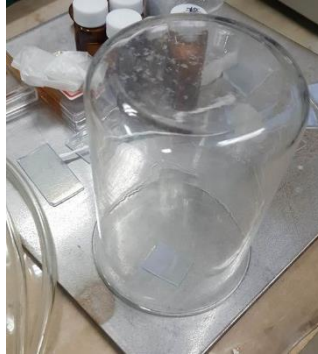
รูปที่ 3.34 การครอบไทเทเนียมไดออกไซด์ที่ปาดแล้วด้วยภาชนะ
