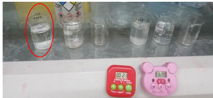
รูปที่ 3.13 จุ่มวัสดุรองรับลงในบีกเกอร์ที่ 1 เลดไดไนเตรตทำละลายในเมทานอล
