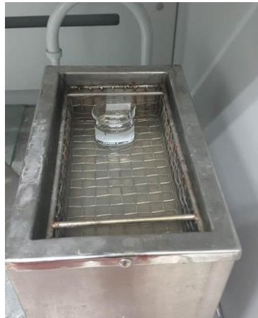
รูปที่ 3.11 ล้างวัสดุรองรับด้วยอะซิโตนในอ่างอัลตราโซนิก
