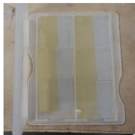
รูปที่ 3.36 กระจกโปร่งแสงนำไฟฟ้า FTO ที่ปาดด้วยไทเทเนียมไดออกไซด์ 4 รอบ
