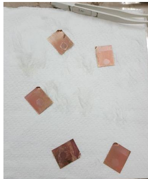
รูปที่ 3.58 แผ่นทองแดงหลังจากจุ่มในกรดไฮโดรคลอริกและล้างด้วยน้ำบริสุทธิ์
