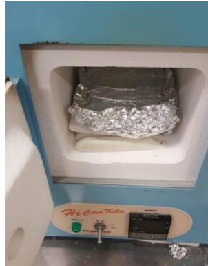
รูปที่ 3.38 นำกระจกโปร่งแสงนำไฟฟ้า FTO ที่ปาดไทเทเนียมไดออกไซด์เข้าตู้อบ
