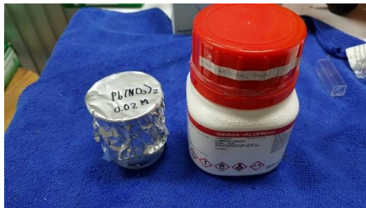
รูปที่ 3.9 ความเข้มข้น 0.02 โมลาร์ ของเลดไดไนเตรต ทำละลายในเมทานอล 50 มิลลิลิตร
