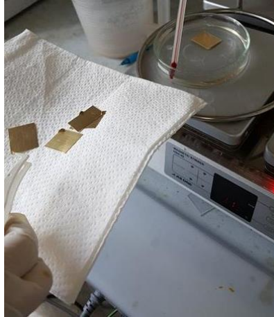
รูปที่ 3.57 แผ่นทองแดงใส่ในภาชนะที่มีกรดไฮโดรคลอริก
