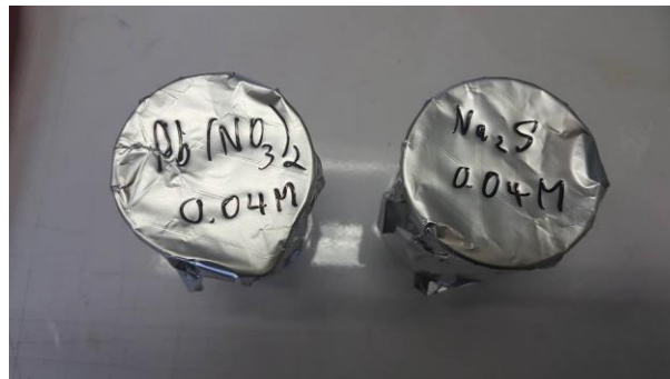
รูปที่ 3.22 ความเข้มข้น 0.04 โมลาร์ของเลดไดไนเตรตและโซเดียมซัลไฟด์ทำละลายในเมทานอล
