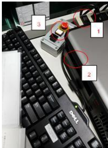
รูปที่ 3.40 สวิตช์ของเครื่องวัดความหนาโดยวิธีเข็มลาก
