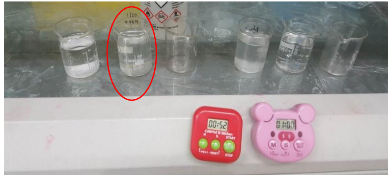
รูปที่ 3.14 จุ่มวัสดุรองรับลงในปีกเกอร์ที่ 2 คือ เมทานอล
