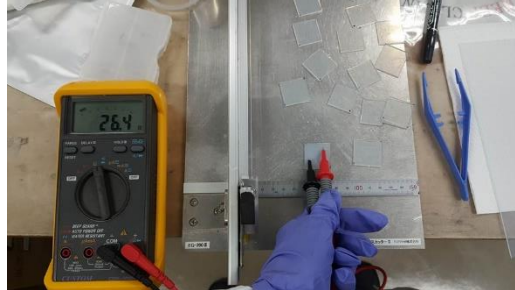
รูปที่ 3.26 ตัดกระจกและวัดความต้านของกระจกโปร่งแสงนำไฟฟ้า FTO
