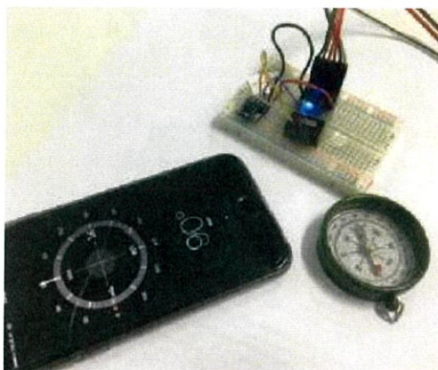
รูปที่ 4.13 การเทียบทิศของโมดูลกับเข็มทิศแบบตลับและแสดงค่าเป็นองศาของทิศตะวันออก
