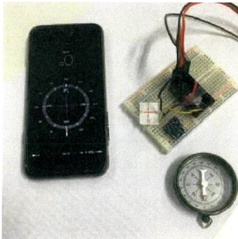
รูปที่ 4.12 การเทียบทิศของโมดูลกับเข็มทิศแบบตลับและแสดงค่าเป็นองศาของทิศเหนือ
