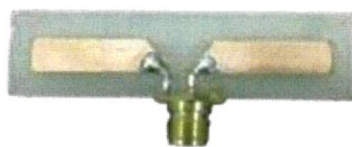
รูปที่ 4.24 Microstrip dipole antenna
