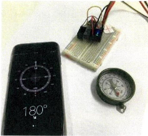
รูปที่ 4.14 การเทียบทิศของโมดูลกับเข็มทิศแบบตลับและแสดงค่าเป็นองศาของทิศได้
