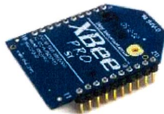
รูปที่ 2.17 โมดูลการสื่อสารไร้สาย XBEE PRO S1 [21]
