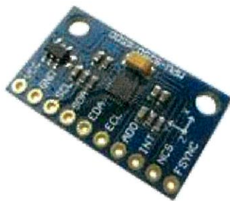
รูปที่ 2.6 เซนเซอร์โมดูล GY-9250 [13]
