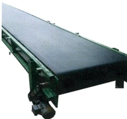
รูปที่ 2.25 สายพานลำเลียงแบบผ้า
