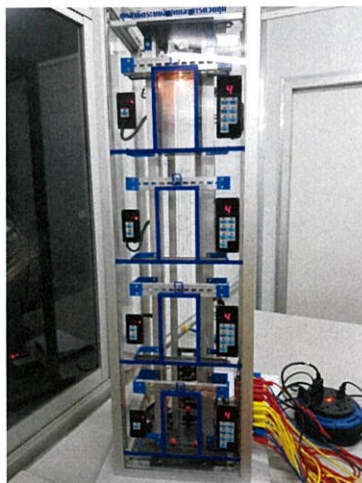
รูปที่ 2.1 ชุดสาธิตระบบลิฟต์
