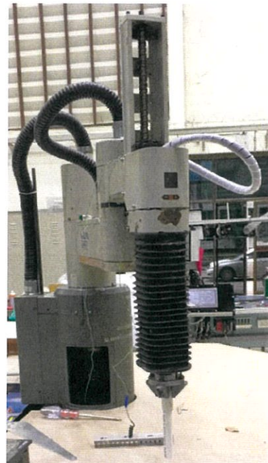
รูปที่ 4.16 ทดสอบ Input จาก Lower Limit Switch ของแกนที่ 3
