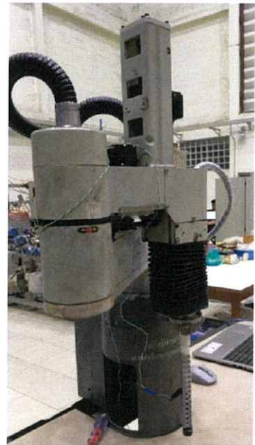
รูปที่ 4.14 ทดสอบ Input จาก Lower Limit Switch ของแกนที่ 2
