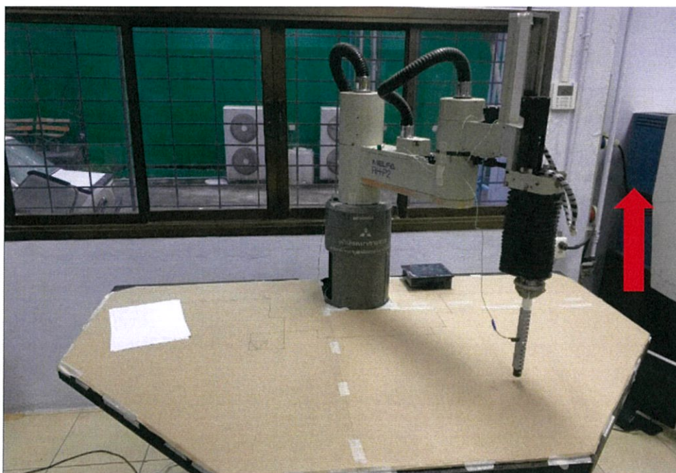
รูปที่ 4.26 การทดลองการเคลื่อนที่แบบ Jog Operation ของแกนที่ 3 แบบ Forward
