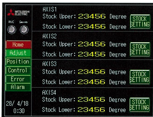
รูปที่ 3.31 หน้าต่างการตั้งค่า Stock Limit
