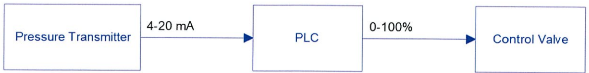
รูปที่ 3.2 ขั้นตอนการควบคุมความดันภายในถัง
