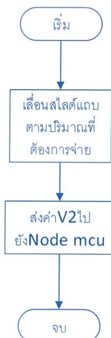
รูปที่ 3.12 แผนผังการทำงานการส่งจ่ายสารละลายกรตไนตริกจาก NETPIE
