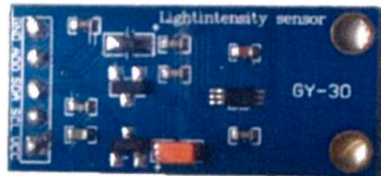
รูปที่ 2.4 โมดูลเซนเซอร์วัดแสงชนิดโฟโตไดโอด BH1750 [32]
