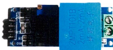
รูปที่ 3.12 เซนเซอร์วัดแรงดันรุ่น ZMPT101B
