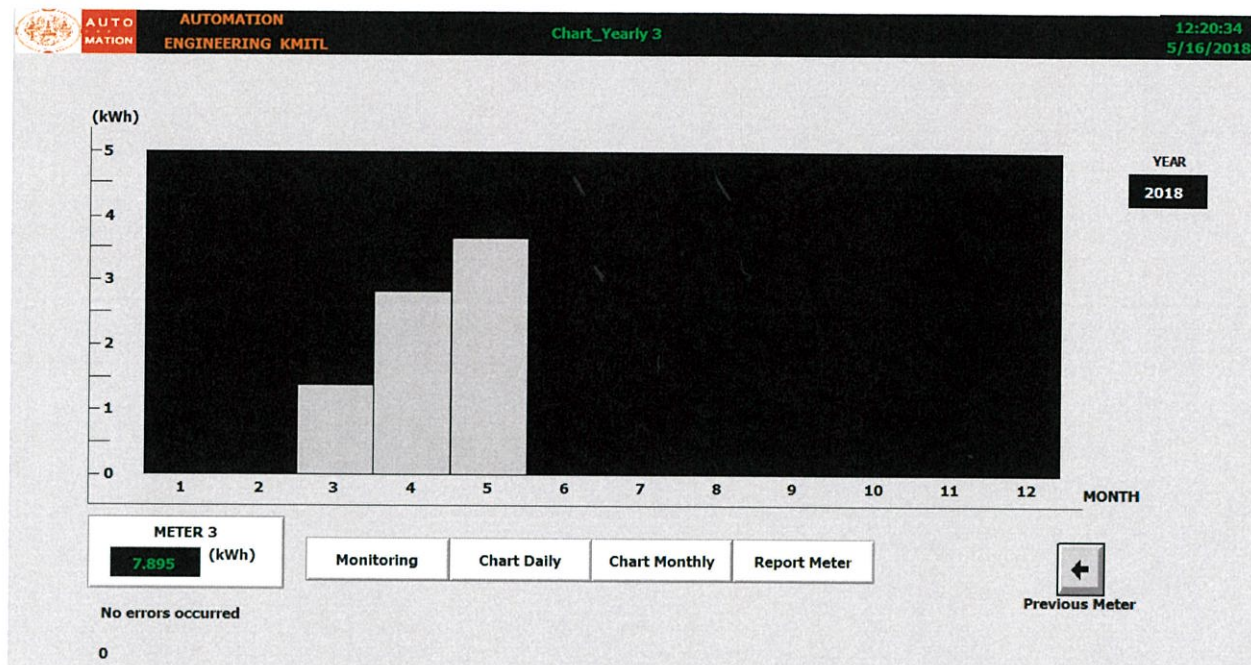
รูป 4.13 แผนภูมิการใช้พลังงานย้อนหลังรายปีของเพาเวอร์มิเตอร์ตัวที่ 3
