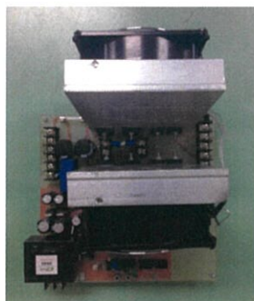
รูปที่ 7 วงจร Phase Shift Full Bridge DC-DC
