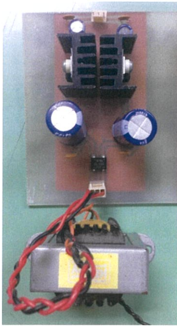
รูปที่ 3.14 วงจรไฟเลี้ยง +15 และ -15 Vdc
