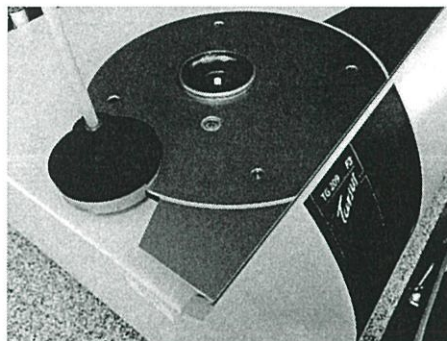
รูปที่ 3.3 การนำถ้วยครุชชีเบลวางลงบนแท่นที่เชื่อมกับเครื่องซึ่งน้ำหนักละเอียดภายในเครื่อง Thermogravimetric Analyzer
