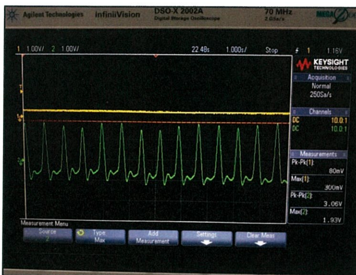
รูปที่ 4.3 Pressure ที่กำลังลดลงเมื่อทำการวัดความดันโลหิต (Channel1) และแสดงสัญญาณ Oscillometric ที่ชัดเจน (Channel2)
