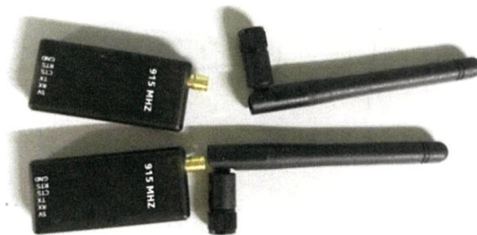
รูปที่ 3.10 ตัวรับ-ส่งสัญญาณวิทยุความถี่ 915 MHz
