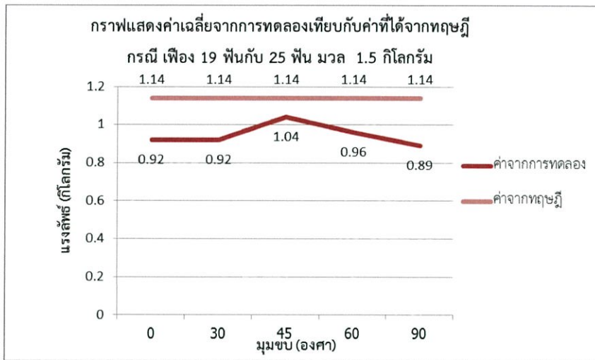
รูปที่ 5.12 แสดงการขบกันกรณี เฟือง 19 ฟันกับ 25 ฟัน มวล 1.5 กิโลกรัม
