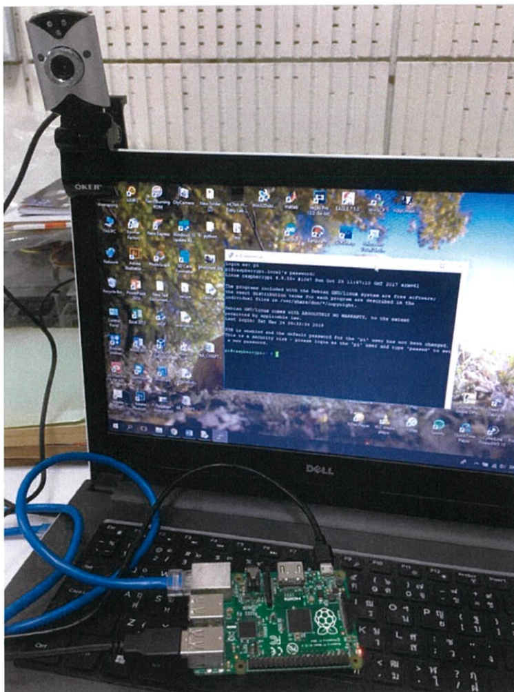
รูปที่ 4.18 เชื่อมต่อราสป์เบอร์รี่ไฟกับกล้องเว็บแคม
