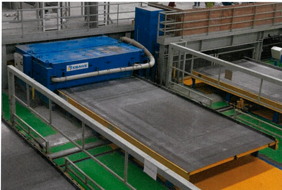
รูปที่ 2.6 ทำความสะอาดและเคลือบน้ำมัน
