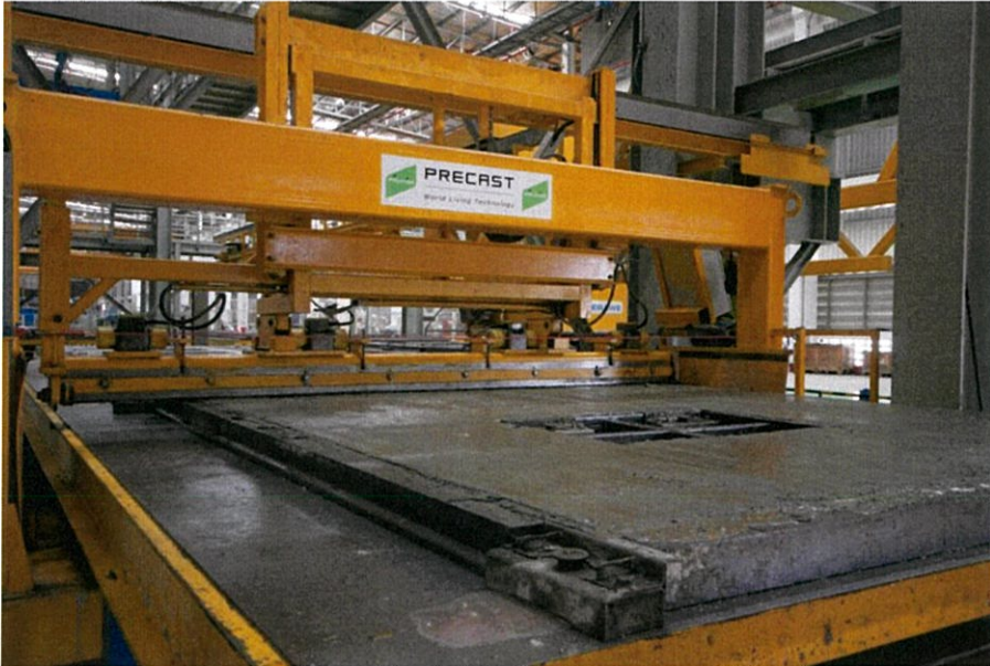
รูปที่ 2.11 การปาดหน้าคอนกรีต
