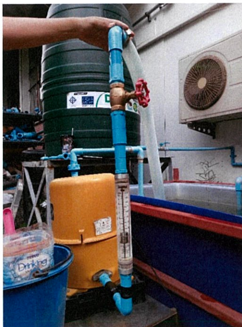
รูปที่ 4.8 ชุดทดลองสำหรับสูบน้ำเพื่อคาลิเบรทโรตاميเตอร์
