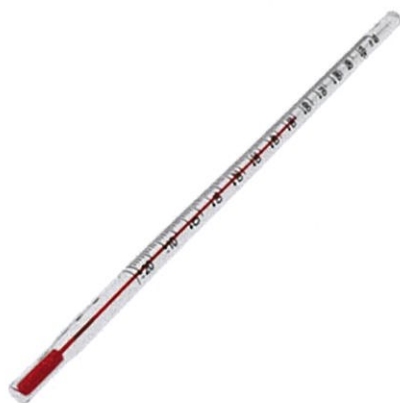
รูปที่ 5.12 เทอร์โมมิเตอร์ชนิดของเหลวบรรจุในหลอดแก้วปิด
