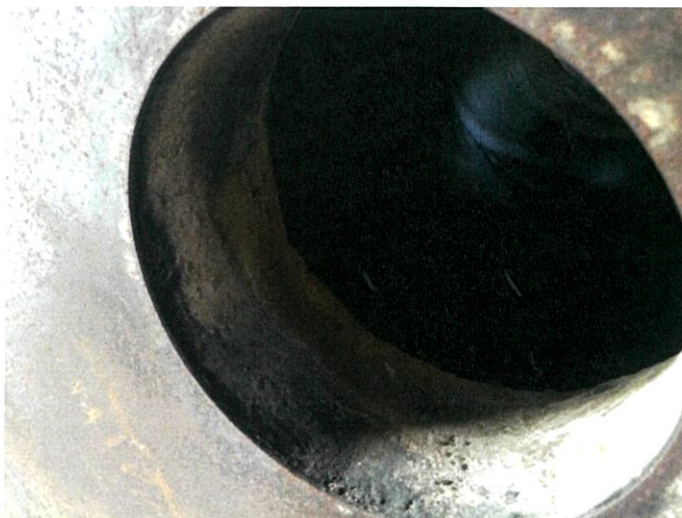
รูปที่ 4.11 ผนังปูนทนไฟภายในหัวเผา
