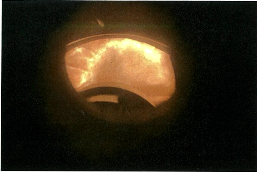
รูปที่ 6.16 ภาพการเผาไหม้ กรณีติดตั้งตัวสร้างการหมุนควงแนวรัศมีแบบแผ่นโค้ง ที่มุม 62 องศา
