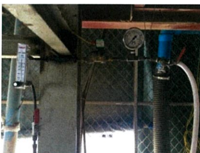
รูปที่ 5.13 ระบบจ่ายแก๊ส LPG ที่ใช้ในการทดลอง
