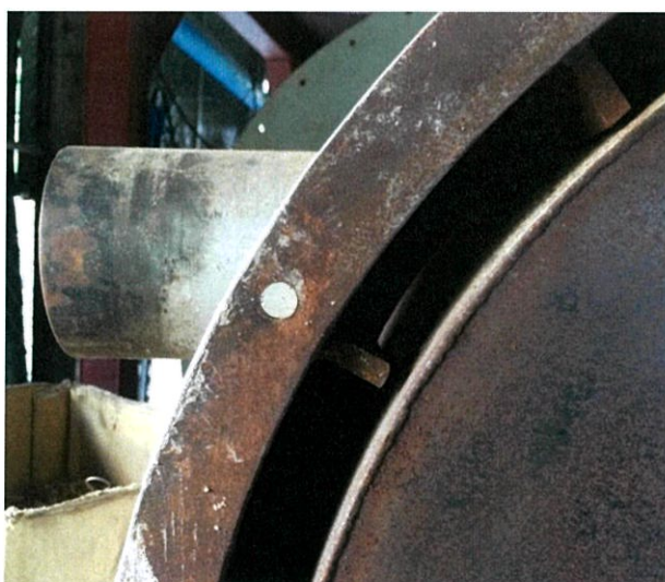
รูปที่ 4.12 ช่องว่างระหว่างปูนทนไฟกับผิวภายนอกของหัวเผา
