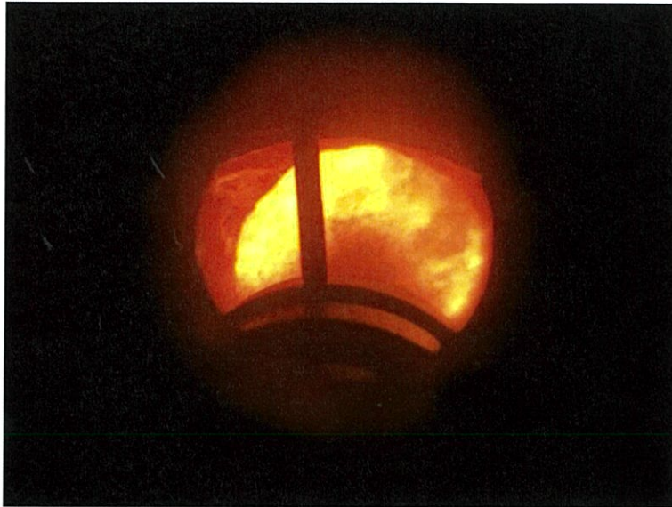
รูปที่ 6.14 ภาพการเผาไหม้ กรณีติดตั้งตัวสร้างการหมุนควงแนวรัศมีแบบแผ่นเรียบ ที่มุม 100 องศา
