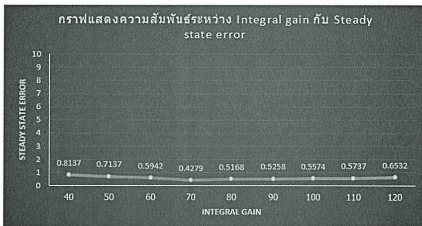
รูปที่ 4.12 กราฟแสดงความสัมพันธ์ระหว่างค่า K_I กับค่า Steady state error
