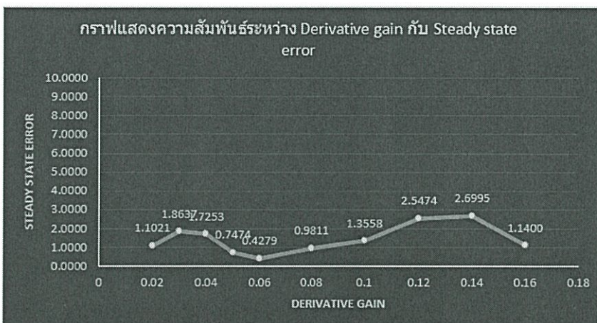
รูปที่ 4.16 กราฟแสดงความสัมพันธ์ระหว่างค่า K_D กับค่า Steady state error
