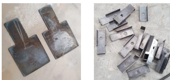
ภาพที่ 4.29 ชิ้นงานที่ได้จากการตัดผ่านเครื่อง และพับ ที่มา : ปิยะกานต์ สุดแสน (2560)
