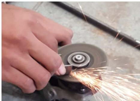
ภาพที่ 4.30 การเจียรตกแต่งชิ้นงาน ที่มา : ปิยะกานต์ สุดแสน (2560)
