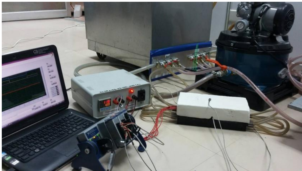
รูปที่ 3.9 ภาพระบบการทดสอบเทอร์โมอิเล็กทริก
