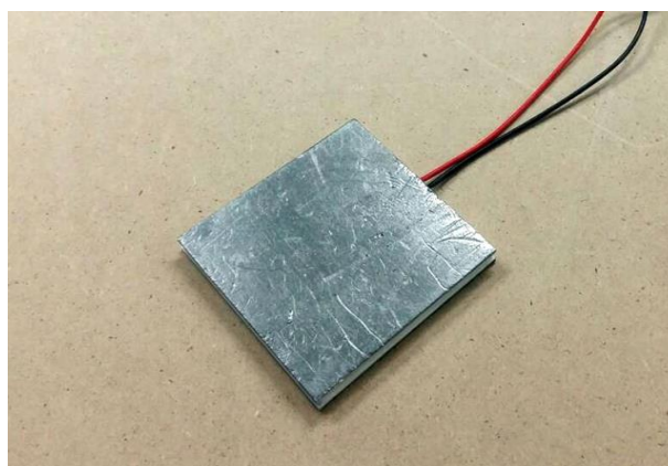
รูปที่ 3.2 เทอร์โมอิเล็กทริกโมดูล รุ่น TELBP1-12656-0.45
