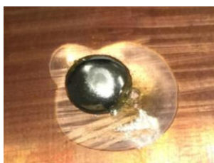
รูปที่ 3.4 สารเชื่อมผสานที่ผ่านการหลอมที่อุณหภูมิ 250 \pm 5 °C เป็นเวลา 30 วินาที
