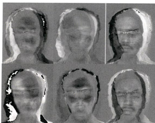
รูปที่ 2.7 Eigenface ที่ได้จากชุดข้อมูลสำหรับการฝึกฝน
