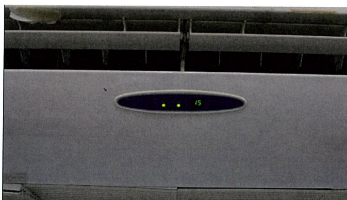
รูปที่ 4.1 ผลการทดสอบระบบควบคุมเครื่องปรับอากาศที่คำสั่ง “เปิดแอร์ 15 องศา
