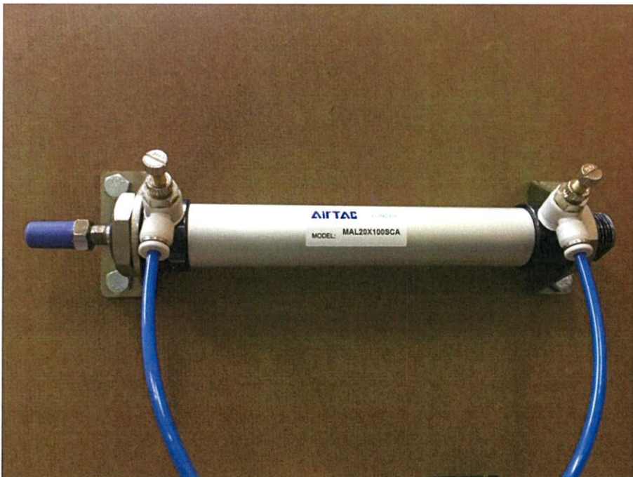
รูปที่ 3.7 กระจบอกลมยี่ห้อ AirTAC รุ่น MAL20 x 100SCALB และตัวปรับความเร็วลมยี่ห้อ AirTAC รุ่น PSL401A
