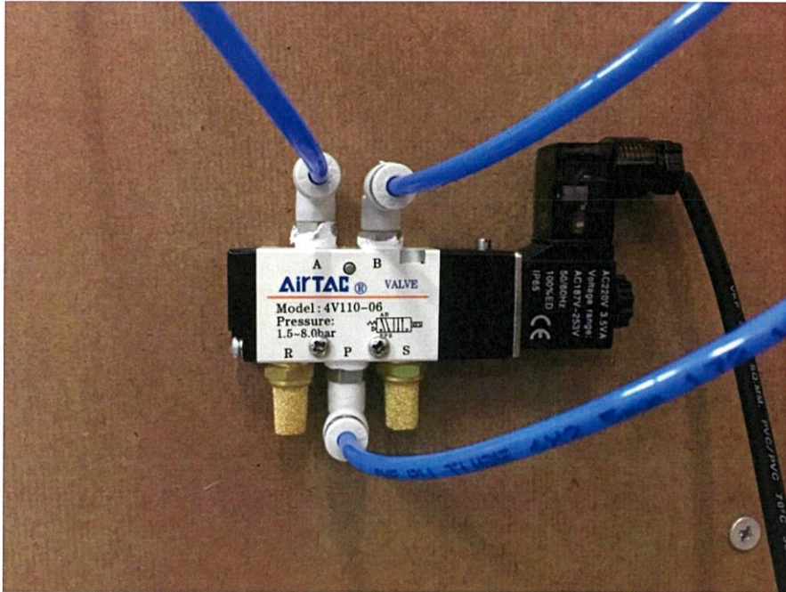
รูปที่ 3.6 โซลินอยด์วาล์วยี่ห้อ AirTAC รุ่น 4V11006A และตัวเก็บเสียงยี่ห้อ AirTAC รุ่น BSL01
