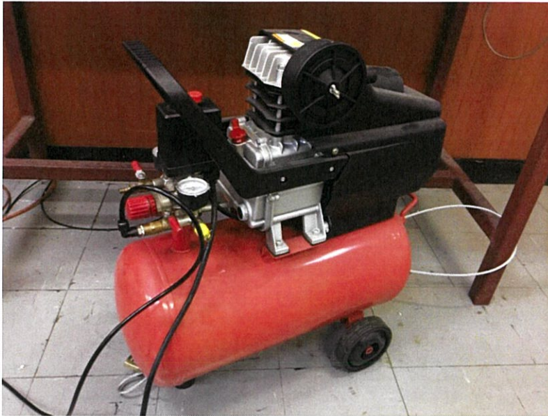
รูปที่ 3.4 ปั๊มลมยี่ห้อ SHIMGE รุ่น ZB-0.1/8
