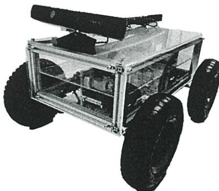
รูปที่ 3.11 ลักษณะการติดตั้งกล้อง Kinect Xbox 360
