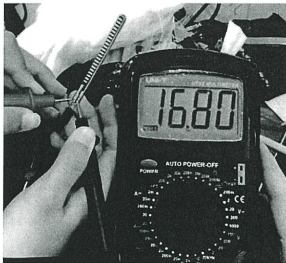
รูปที่ 3.10 วัดความต้านทานของเฟลคเซนเซอร์ที่ 0 องศา โดยใช้มิเตอร์ได้ 16.8 k \Omega
