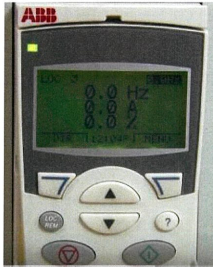
รูปที่ 3.10 การเลือก Inverter ให้สามารถควบคุมโดย PLC
