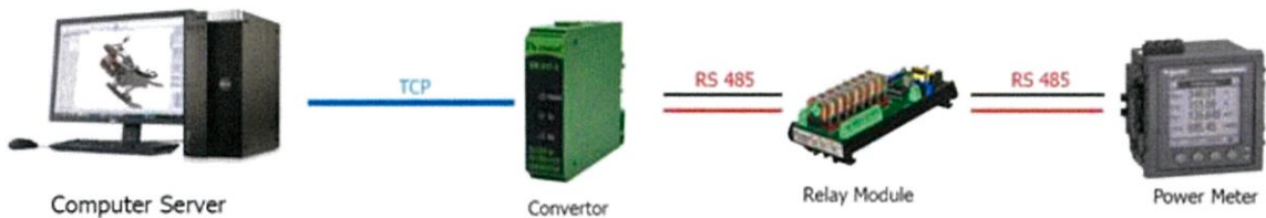
ภาพที่ 3.5 ภาพรูปแบบการสื่อสารระหว่าง Server ไปยังอุปกรณ์ปลายทาง
