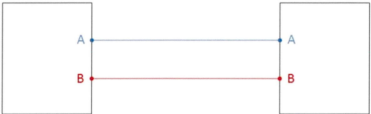
ภาพที่ 2.10 ภาพตัวอย่างการเชื่อมต่อ RS485 ระหว่างเครื่องมือวัดกับตัวแปลงสัญญาณ
