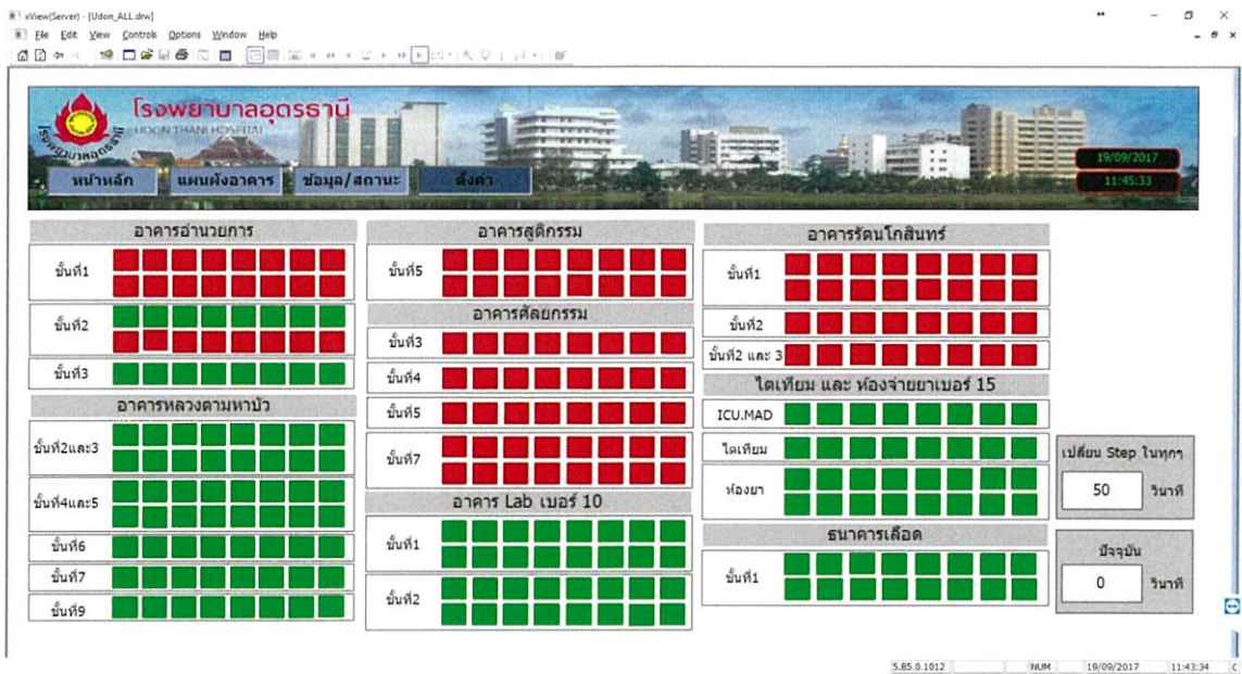
ภาพที่ 4.6 ภาพการสั่งงาน Relay Module ผ่านโปรแกรม Team Viewer จากคอมพิวเตอร์
