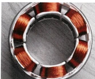
รูปที่ 2.16 Stator Winding
