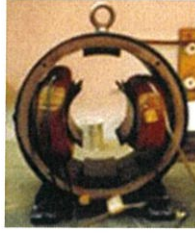
รูปที่ 2.10 ภาพขดลวดพันอยู่รอบขั้วแม่เหล็ก (2)
