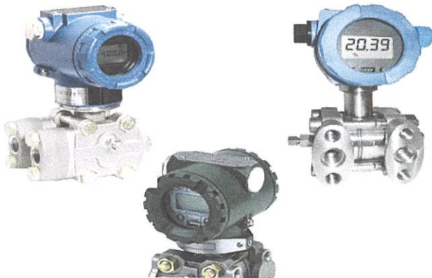
ภาพที่ 3.9 แสดงเครื่องมือวัดความดันแตกต่าง (Differential Pressure Transmitter)
