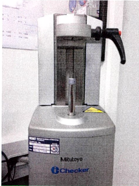
ภาพที่ 3.23 การวอร์มหัววัดของเครื่อง i-Checker
