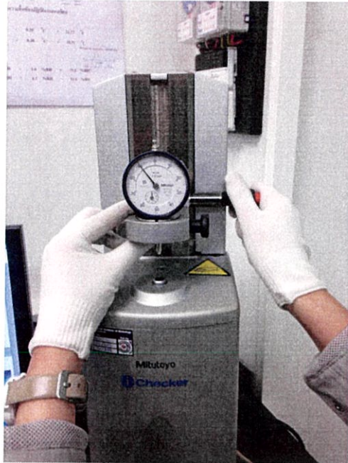
ภาพที่ 3.22 แสดงการติดตั้งไดอัลเกจกับ Stand ของเครื่อง i-Checker
