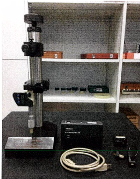
ภาพที่ 3.10 ไดอัลเกจทดสอบเตอร์, U-Wave-T และ U-Wave-R
