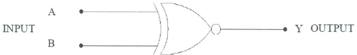
ภาพที่ 2.14 สัญลักษณ์เอ็กซ์คลูซีฟนอร์เกต
