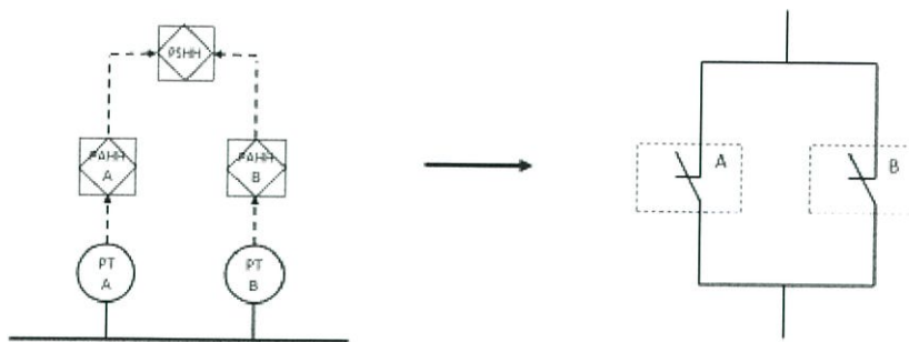
อุปกรณ์วัดแบบ 2oo2 บนแผนภาพกระบวนการผลิต
