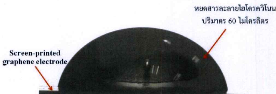
รูปที่ 3.3 Side view จากการถ่ายภาพด้วยเครื่อง contact angle ลักษณะของหยดสารละลายไฮโดรควิโนนที่บริเวณหน้าขั้วไฟฟ้ากราฟีนแบบพิมพ์สกรีน
