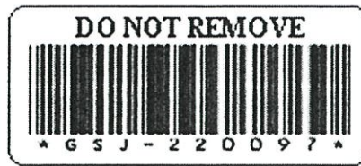
รูปที่ 2.3 ตัวอย่าง Barcode Code 39
