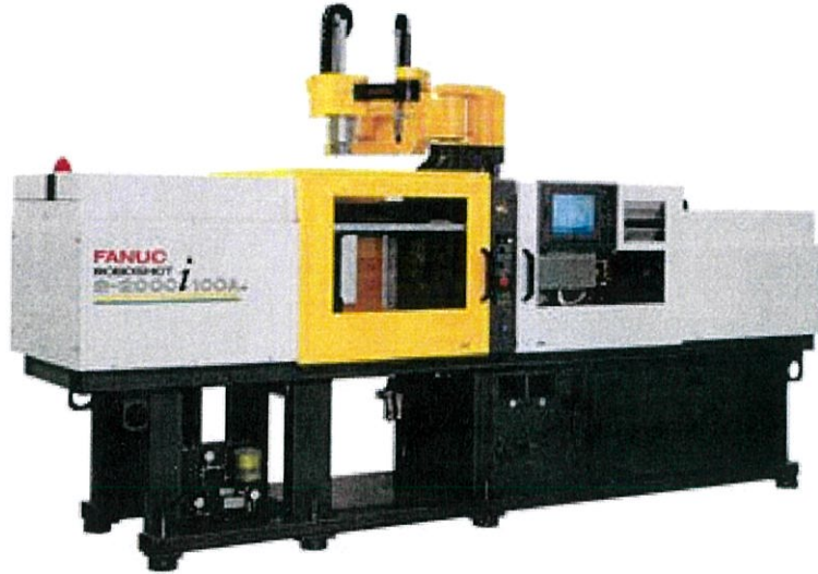
รูปที่ 3.4 เครื่องฉีดพลาสติกที่ใช้ในกระบวนการผลิตชิ้นส่วนกรณีศึกษา
