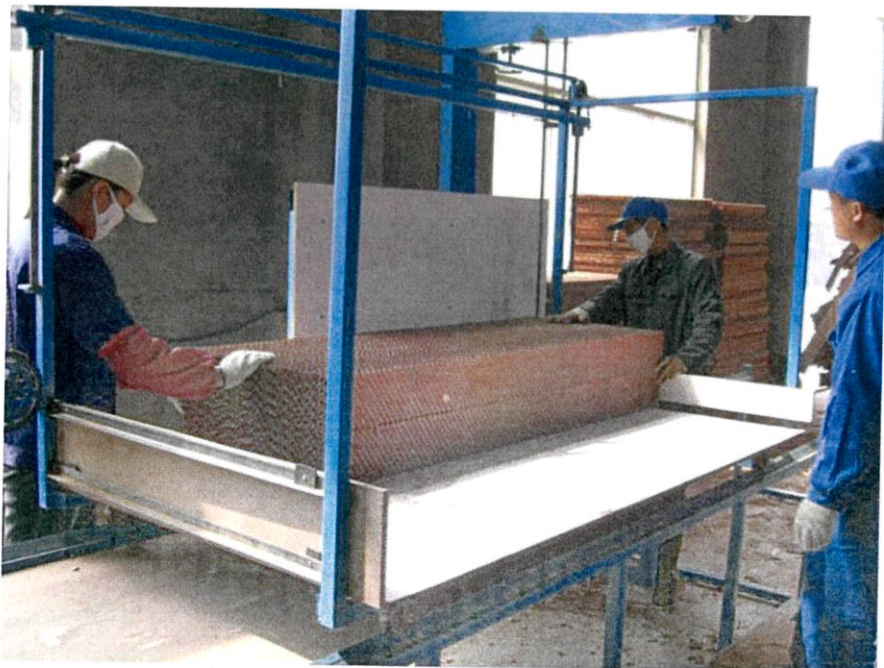
รูปที่ 2.14 นำเข้าเครื่องตัดให้ได้ขนาดที่ต้องการ ( ที่มา : www.b-inter.com )
