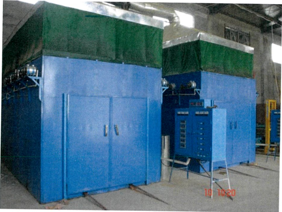
รูปที่ 2.13 อบด้วยความร้อน 100 –105 °C ( ที่มา : www.b-inter.com )
