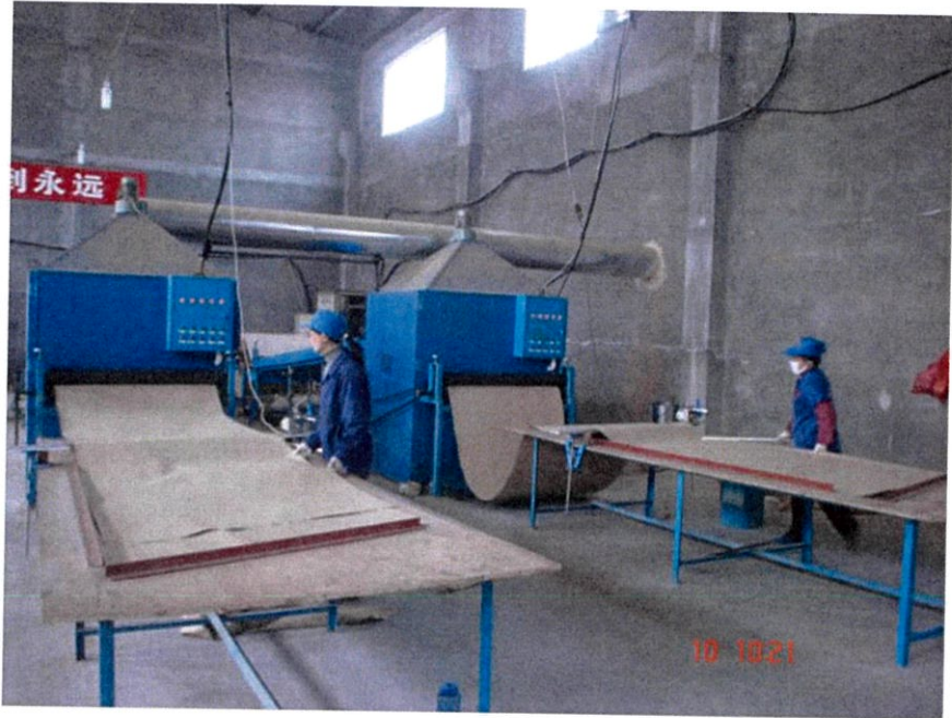
รูปที่ 2.9 อบเยื่อกระดาษให้แห้ง และตัดขนาด ( ที่มา : www.b-inter.com )
