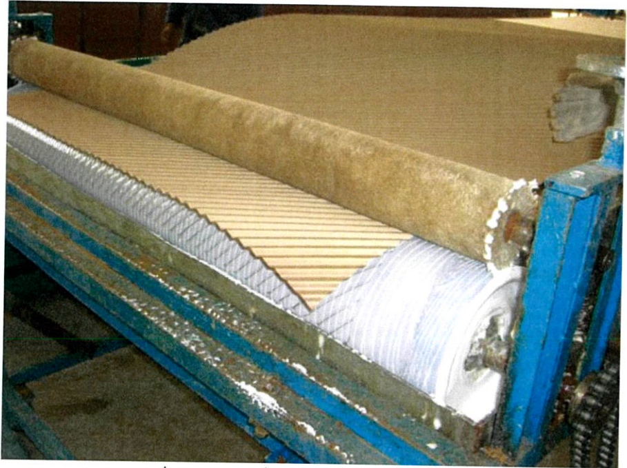
รูปที่ 2.11 นำเยื่อกระดาษเขาเครื่องทากาว ( ที่มา : www.b-inter.com )
