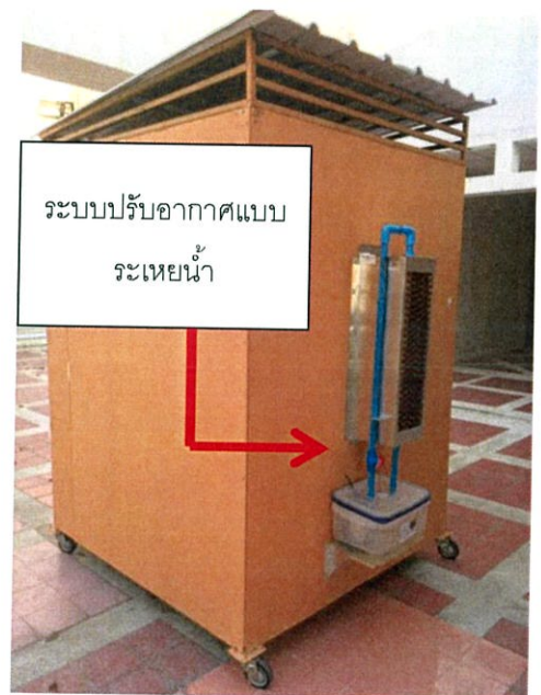
(ข) ด้านที่ติดตั้งพัดลมระบบประหยัดพลังงาน ( Evaporative Cooling System )
