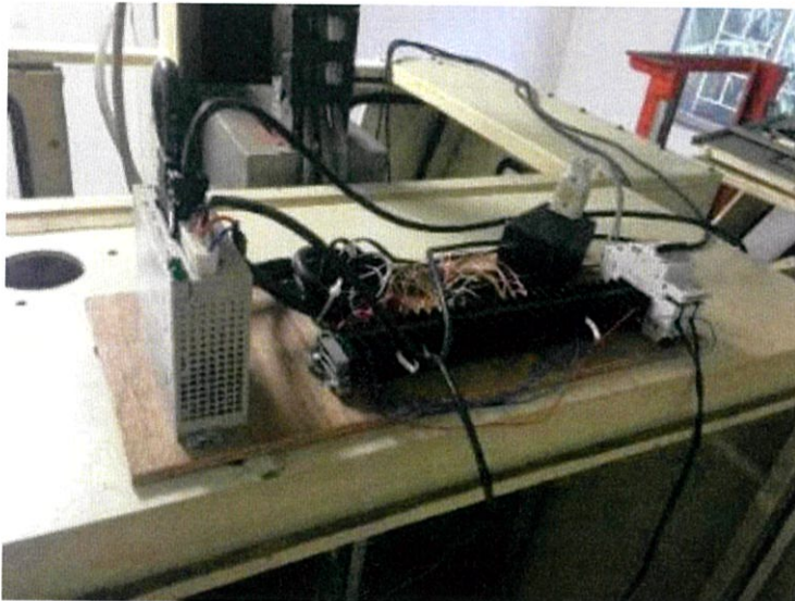
รูปที่ 3.16 การนำวงจรชุดขับไปติดตั้งกับเครื่องกัด CNC
