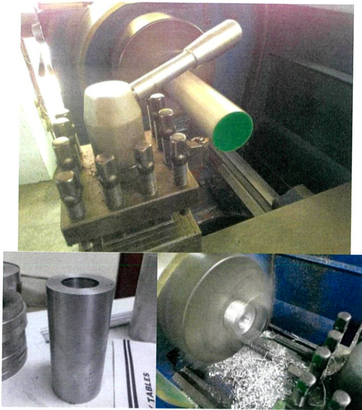
รูปที่ 3.18 การกลึงเพลาอลูมิเนียม และการเจาะรูเพลาอลูมิเนียม
