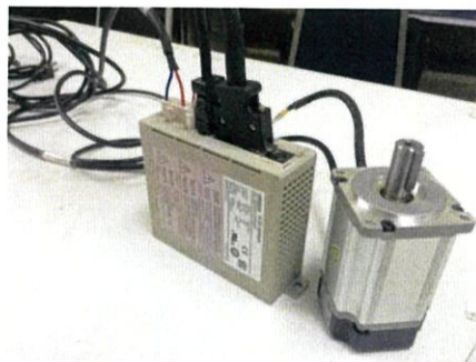
รูปที่ 3.13 มอเตอร์ Omron R88M-G40030H พร้อมทั้ง ชุด Motor Drive
