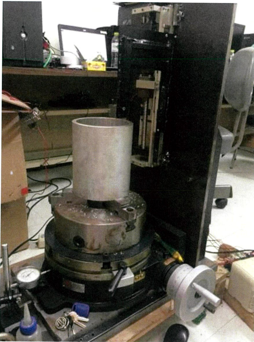
รูปที่ 4.6 เครื่องไสแนวตั้งทำชุดเฟืองใน
