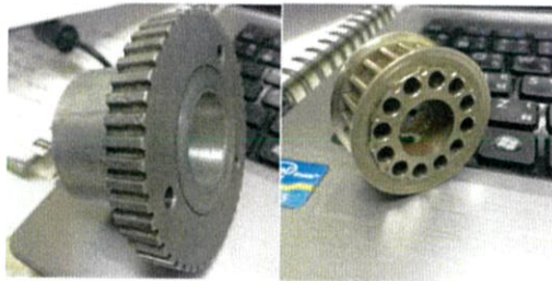
รูปที่ 3.15 พูลเลย์ใหม่มีขนาด 20 ฟัน และ 48 ฟัน
