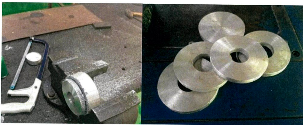
รูปที่ 3.19 การเลื่อยตัดเพลาพร้อมทั้งกลึงปาดหน้า
