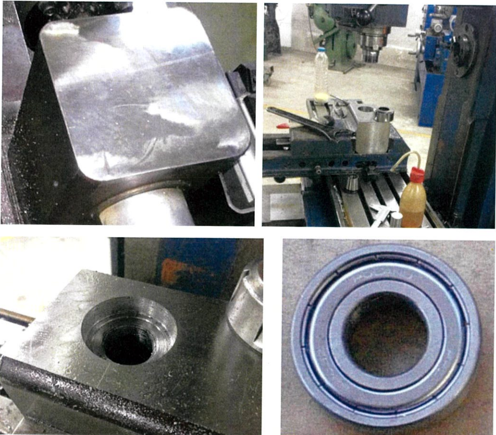
รูปที่ 3.10 เหล็กสี่เหลี่ยมสำหรับทำป้อมแกนมุมนและลูกปืนเบอร์ 620677
