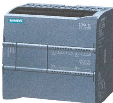
รูปที่ 3.5 หน่วยประมวลผล SIMATIC S7-1200 ของบริษัท Siemens
