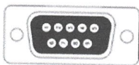
รูปที่ 2.8 DB9 ตัวผู้ เมื่อมองจากด้านหลัง
