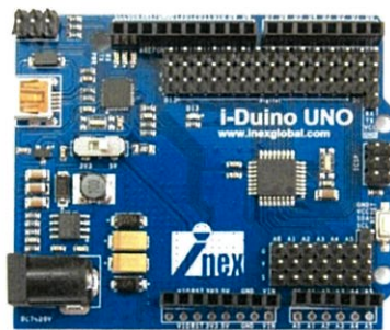
รูปที่ 3.6 บอร์ด Arduino ใช้เป็นไมโครคอนโทรลเลอร์ในการควบคุมมอเตอร์
