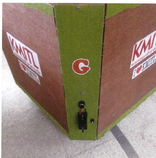
รูปที่ ก.1 Circuit breaker ของระบบ
