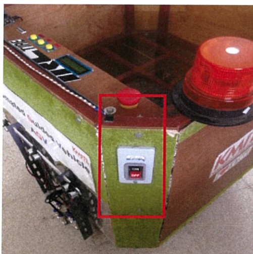
รูปที่ ก.2 ปุ่ม Emergency switch และ ปุ่มเปิด-ปิดชุด BLDC motor drive
