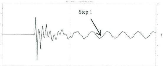
รูปที่ 4 กราฟแสดงพฤติกรรมกระแสไหลพุ่งของเฟส A ในการตัดต่อวงจรตัวเก็บประจุกรณีไม่มีการต่อรีแอกเตอร์ ลำดับชั้นที่หนึ่ง
