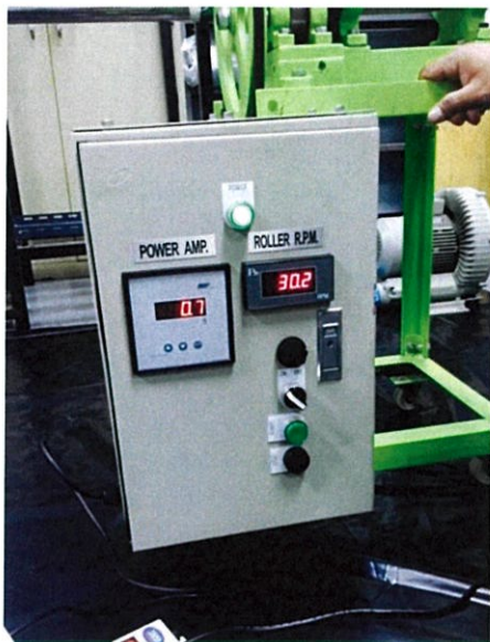
รูปที่ ค.3 ตู้ Control ปรับความเร็วรอบหัวรีด
