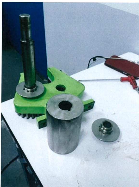
รูปที่ ข.6 ถอดชิ้นส่วนของทั้ง 3 หัวรีด เปลี่ยนอีกหัวใส่เข้าไป
