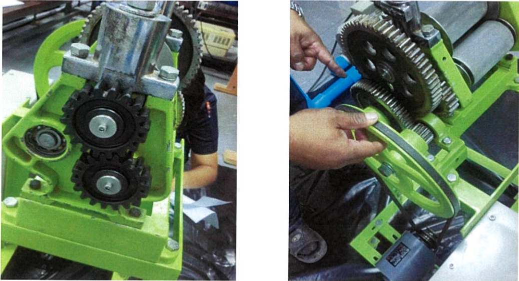
รูปที่ 2.8 ระบบของเฟือง เพลา และสายพานที่ใช้ในเครื่องหีบอ้อยขนาดเล็ก
