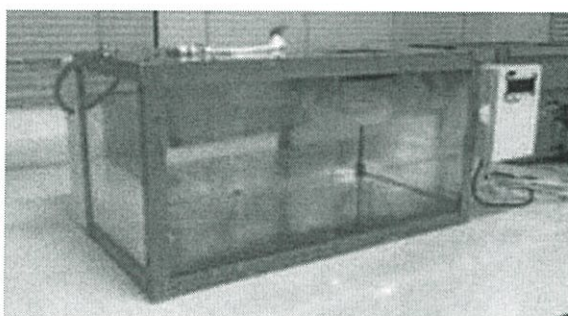
รูปที่ 3.3 เครื่องเคลื่อนผิวพร้อมชุดเป่าแห้งสำหรับไขไก่สด (ด้านหน้า)
