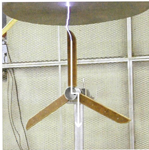
รูปที่ 4.15 การเบรกดาว์นของอากาศผ่านแบบจำลองกังหันลม ที่ติดตั้งการป้องกันฟ้าผ่าแบบติดตั้งตัวรับฟ้าผ่า ระยะระหว่างอิเล็กโตรดกับใบพัด 20 cm ที่ใบพัดอยู่ในตำแหน่ง A
