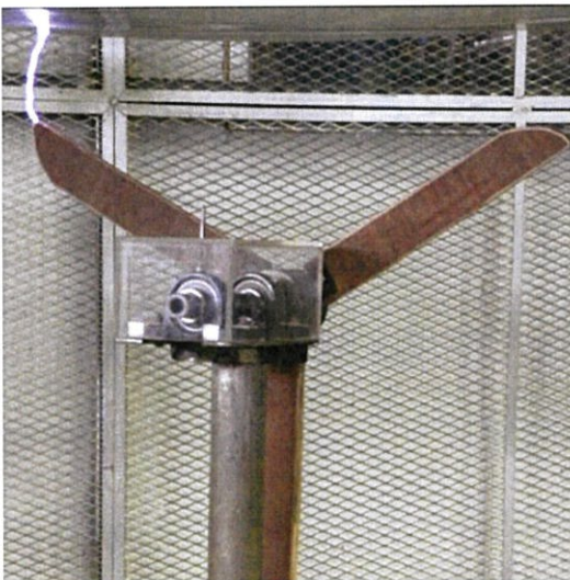
รูปที่ 4.20 การเบรกดาว์นของอากาศผ่านแบบจำลองกังหันลม ที่ติดตั้งการป้องกันฟ้าผ่าแบบติดตั้งตัวนำแบบโครงตาข่าย ระยะระหว่างอิเล็กโตรดกับใบพัด 20 cm ที่ใบพัดอยู่ในตำแหน่ง B
