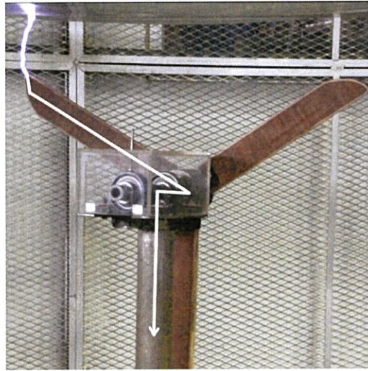
รูปที่ 4.20 การเบรกดาว์นของอากาศผ่านแบบจำลองกังหันลม ที่ติดตั้งการป้องกันฟ้าผ่าแบบติดตั้งตัวนำแบบโครงตาข่าย ระยะระหว่างอิเล็กโตรดกับใบพัด 20 cm ที่ใบพัดอยู่ในตำแหน่ง B
