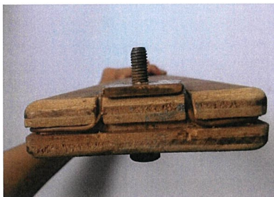
รูปที่ 3.29 ภาพรวมใบพัดแบบ B (ก) องค์ประกอบของใบพัด (ข) ตัวรับฟ้าผ่าและตัวนำลงดินของใบพัด
