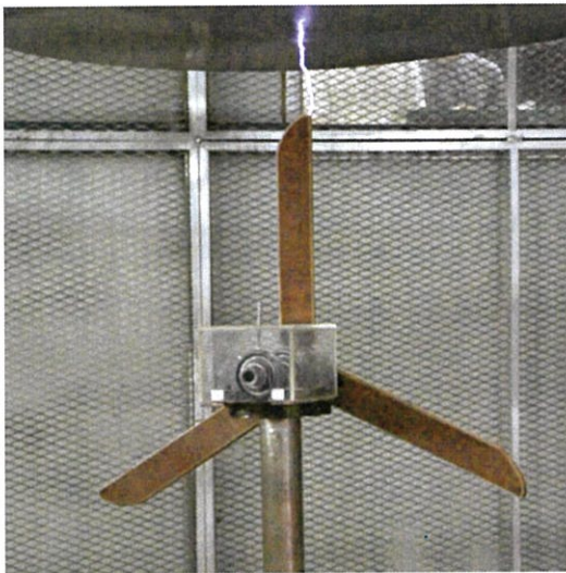
รูปที่ 4.19 การเบรกดาว์นของอากาศผ่านแบบจำลองกังหันลม ที่ติดตั้งการป้องกันฟ้าผ่าแบบติดตั้งตัวนำแบบโครงตาข่าย ระยะระหว่างอิเล็กโตรดกับใบพัด 20 cm ที่ใบพัดอยู่ในตำแหน่ง A
