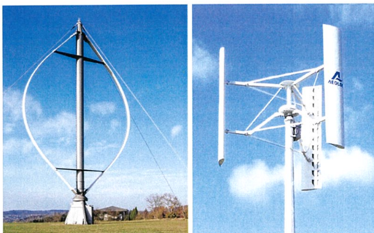
รูปที่ 2.12 กังหันลมแกนหมุนแนวตั้งชนิดขับเคลื่อนด้วยแรงยก
