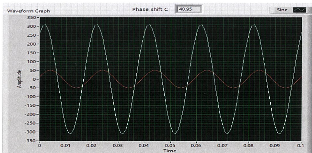
รูปที่ 4.19 มุมต่างเฟส V_{c-lc} ที่แรงดัน 220 โวลต์ของ RL Load จาก DAQ และ LabVIEW
