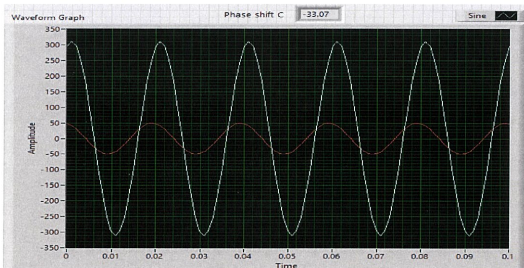
รูปที่ 4.25 มุมต่างเฟส V_c-I_c ที่แรงดัน 55 โวลต์ของ RC Load จาก DAQ และ LabVIEW
