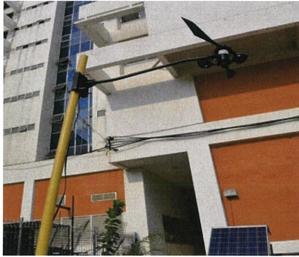
รูปที่ 3.32 Anemometer รุ่น DAVIS7911
