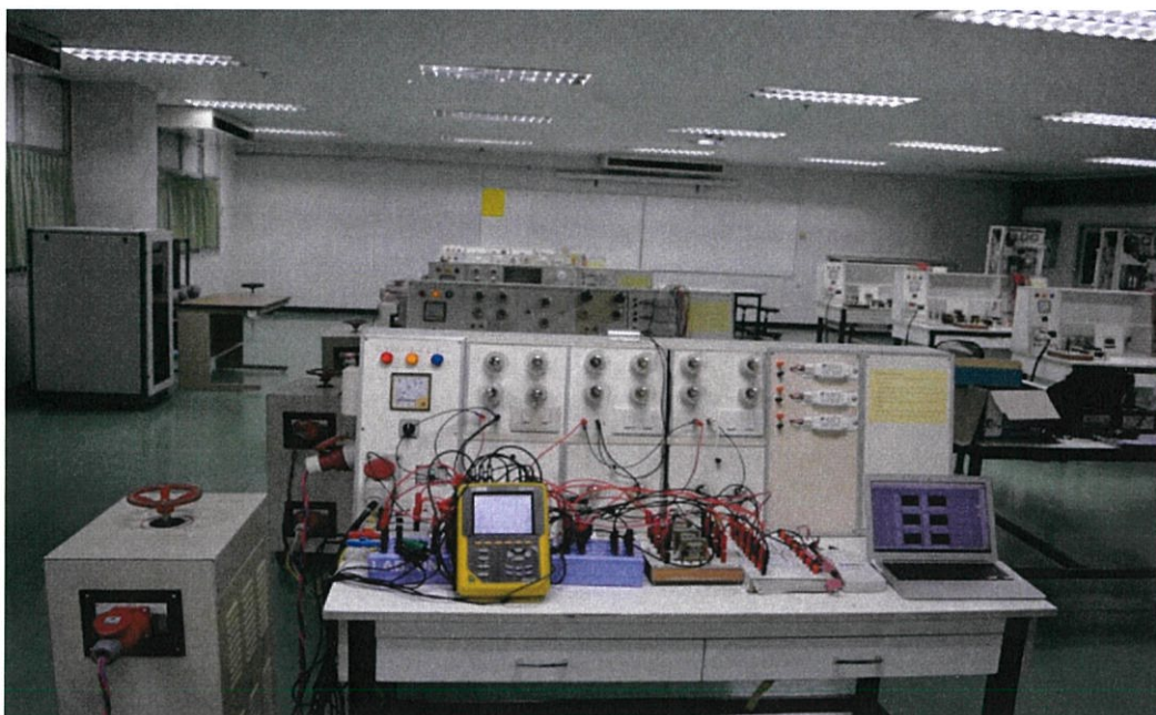
รูปที่ 4.21 การทดสอบหาค่าเปรียบเทียบมุมเฟสที่เกิดจากหม้อแปลงกระแส ในกรณี RC load โหลดที่ใช้คือหลอดเฝ้าไส้และตัวเก็บประจุขนาด 10 \mu\text{F}
