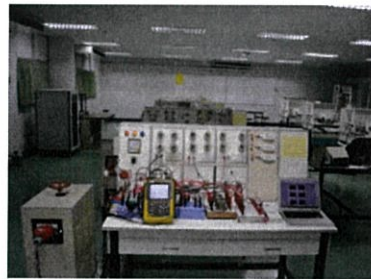
รูปที่ 9 การทดสอบเพื่อหาค่าแก้ไขแก่ชุดอุปกรณ์
