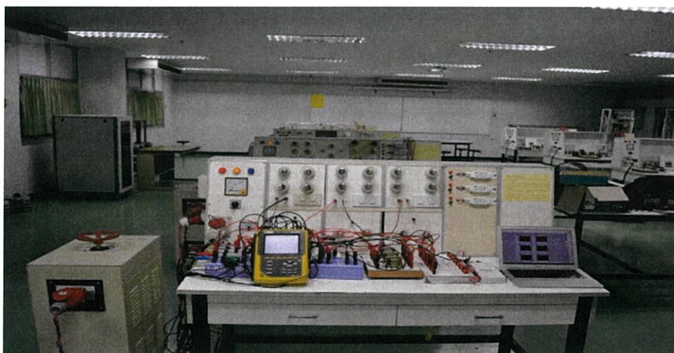
รูปที่ 4.3 การทดสอบหาค่าเปรียบเทียบอัตราส่วนของชุดอุปกรณ์
