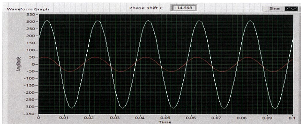
รูปที่ 4.13 มุมต่างเฟส V_c-I_c ที่แรงดัน 220 โวลต์ของ R Load จาก DAQ และ LabVIEW
