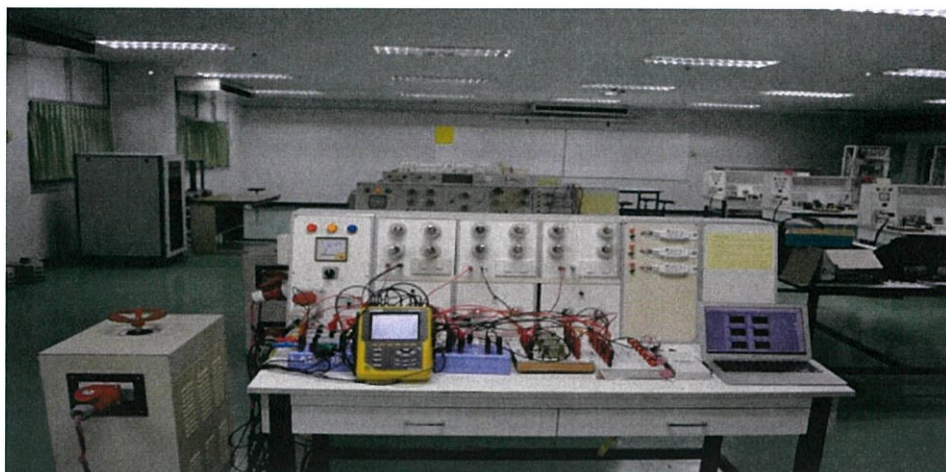
รูปที่ 4.9 การทดสอบหาค่าเปรียบเทียบมุมเฟสที่เกิดจากหม้อแปลงกระแส ในกรณี R load
