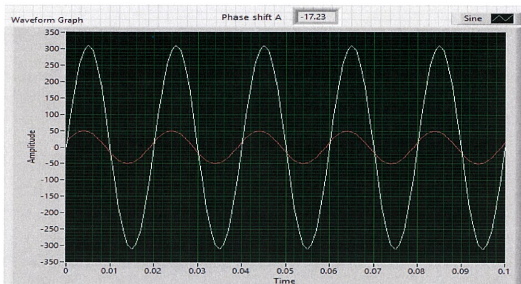
รูปที่ 4.7 มุมต่างเฟส V-I ที่แรงดัน 220 โวลต์ของ Linear Load ด้านเอาต์พุตจากชุดเครื่องมือวัด
