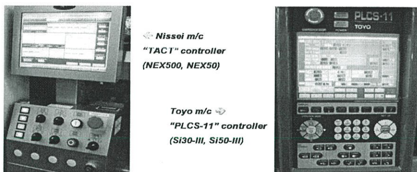
รูปที่ 2.7 ชุดควบคุมของเครื่องฉีดพลาสติก (เขาวลิต เจริญรักษา, 2554)
