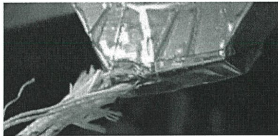
รูปที่ 4.4 ตำแหน่งการติดตั้งเทอร์โมคัปเปิลเข้ากับเทอร์โมคัปเปิล
