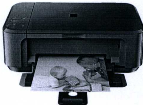
รูปที่ 2.29 เครื่องพิมพ์แบบหัวพ่นหมึก (Ink Jet)
