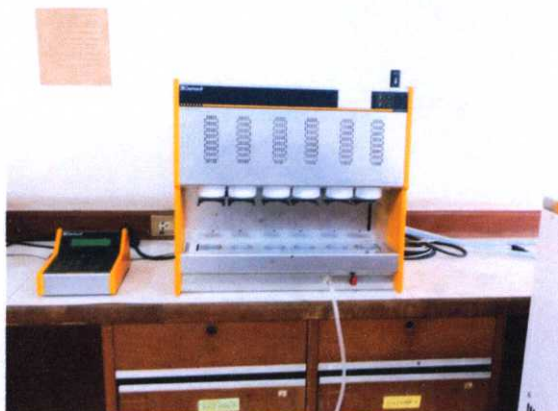
ภาพที่ 3.7 เครื่องสกัดไขมัน (Fat extraction)แบบ Soxtherm ยี่ห้อ Gerhardt
