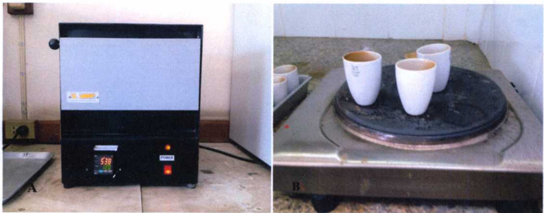
ภาพที่ 3.5 เตาเผาอุณหภูมิสูง (Muffle furnace) (A) และถ้วยกระเบื้อง (B)
