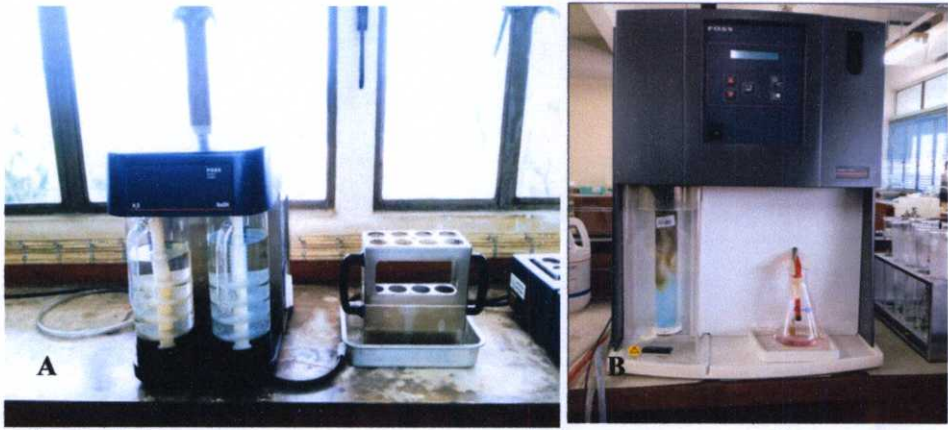
ภาพที่ 3.6 เครื่องดูดจำกัดไอกรด (Scrubber unit) ยี่ห้อ FOSS (A) และเครื่องกลั่นโปรตีน/ไนโตรเจน (Distilling unit) ยี่ห้อ FOSS (B)
