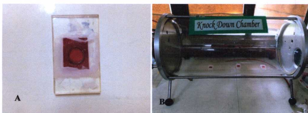
ภาพที่ 3.2 กรงทดสอบ (A) และเครื่อง Knockdown Chamber (B)
