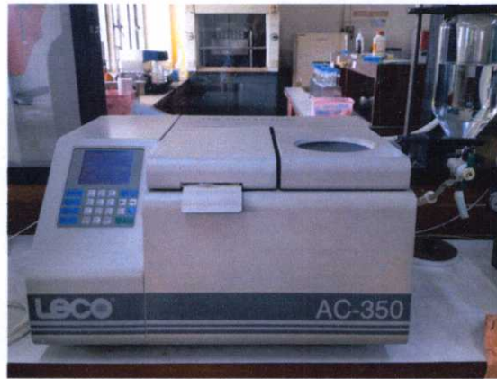
ภาพที่ 3.9 เครื่องวิเคราะห์พลังงานในตัวอย่างอาหารสัตว์ (Automatic bomb calorimeter) รุ่น AC-350
