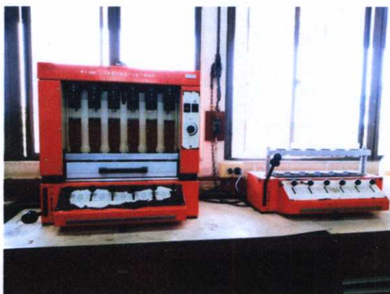
ภาพที่ 3.8 เครื่องวิเคราะห์เยื่อใย (Fibertec System) ยี่ห้อ FOSS รุ่น M6
